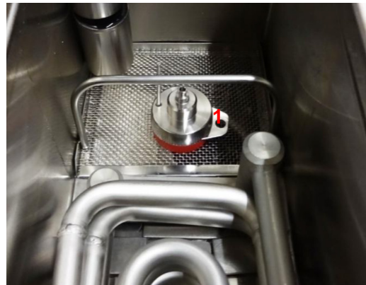
Abb. 4 Sensorplatzierung im Kammersumpf.
